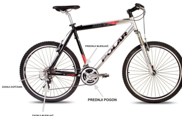
Na lijevoj strani volana se nalazi ručica prednjeg mjenjača koji vrši prebacivanje lanca na 3 glavne šajbne srednjeg pogonskog mehanizma.Prebacivanje brzina na prednjem mjenjaču se vrši kod konkretnijih promjena (različite konfiguracije terena ili potpuna promjena dinamike vožnje-naglo ubrzavanje ili usporenje).
